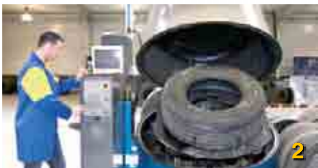
KROK 2 Kontrola na sherographie: nieinwazyjna lokalizacja uszkodzeń konstrukcji karkasu
