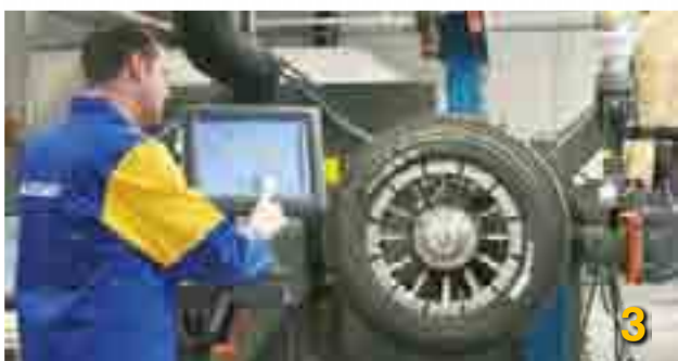
KROK 3 Szorstkowanie: usunięcie pozostałości starego bieżnika, przywrócenie właściwej geometrii
