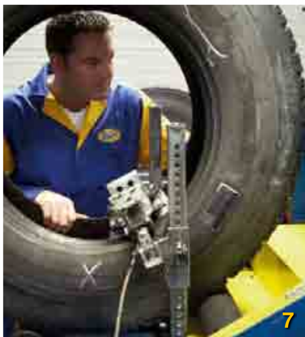
KROK 7 Końcowa kontrola: sprawdzenie jakości procesu bieżnikowania
