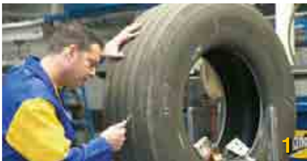
KROK 1 Kontrola wstępna: oględziny zewnętrzne karkasu
