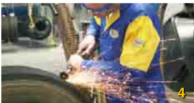
KROK 4 Szlifowanie i wypełnianie ubytków: pozwala naprawić i uratować wartościowe karkasy
